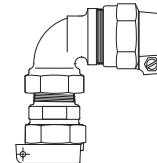
PACK JOINT FOR COPPER OR PLASTIC TUBING (CTS) BY PACK JOINT FOR PVC PIPE,
