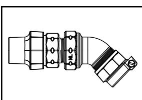
FLARE COPPER INLET BY PACK JOINT FOR PLASTIC OR COPPER TUBING (CTS) OUTLET,
