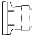
FEMALE FLANGED LEAD THREAD INLET BY QUICK JOINT FOR COPPER OR PLASTIC TUBING (CTS) OUTLET
