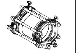
4" - 12" STYLE RCDD FOR JOINING DUCTILE IRON PIPE OF THE SAME NOMINAL SIZE
