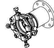
**3"-8" RESTRAINED ADAPTER FOR CONVERTING PLAIN END PIPE TO A FLANGE CONNECTION
