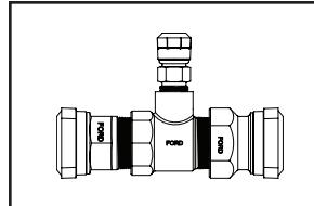
QUICK JOINT FOR CTS TO QUICK JOINT FOR CTS ON THE RUN BY FEMALE IRON PIPE SIDE OUTLET WITH C84-43-Q-NL COUPLING (MALE IRON PIPE BY QUICK JOINT FOR CTS) ASSEMBLED WATERTIGHT
